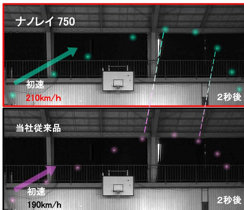
→当社従来品と比較しクリアの初速約 20km/h(190km/h→210km/h)アップ。コート奥まで早く届き、決定打に繋げられるスピードクリアを打ち出すことが可能です。
